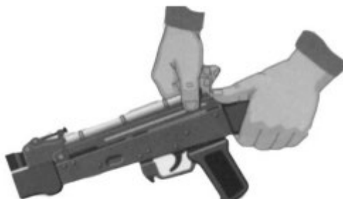
Рисунок 7 – Отделение крышки ствольной коробки
