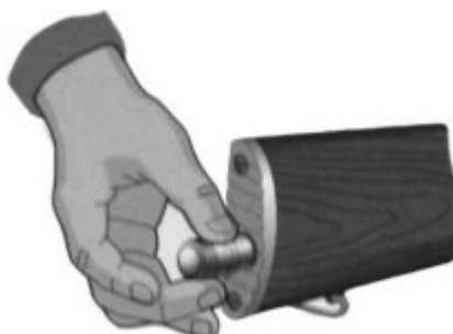
Рисунок 5 – Извлечение пенала с принадлежностями
