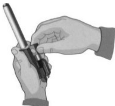
Рисунок 10 – Отделение затвора от затворной рамы
