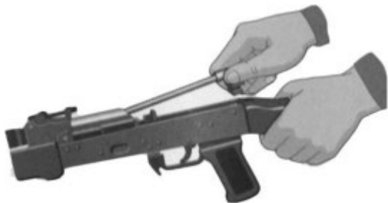
Рисунок 8 – Отделение возвратного механизма
